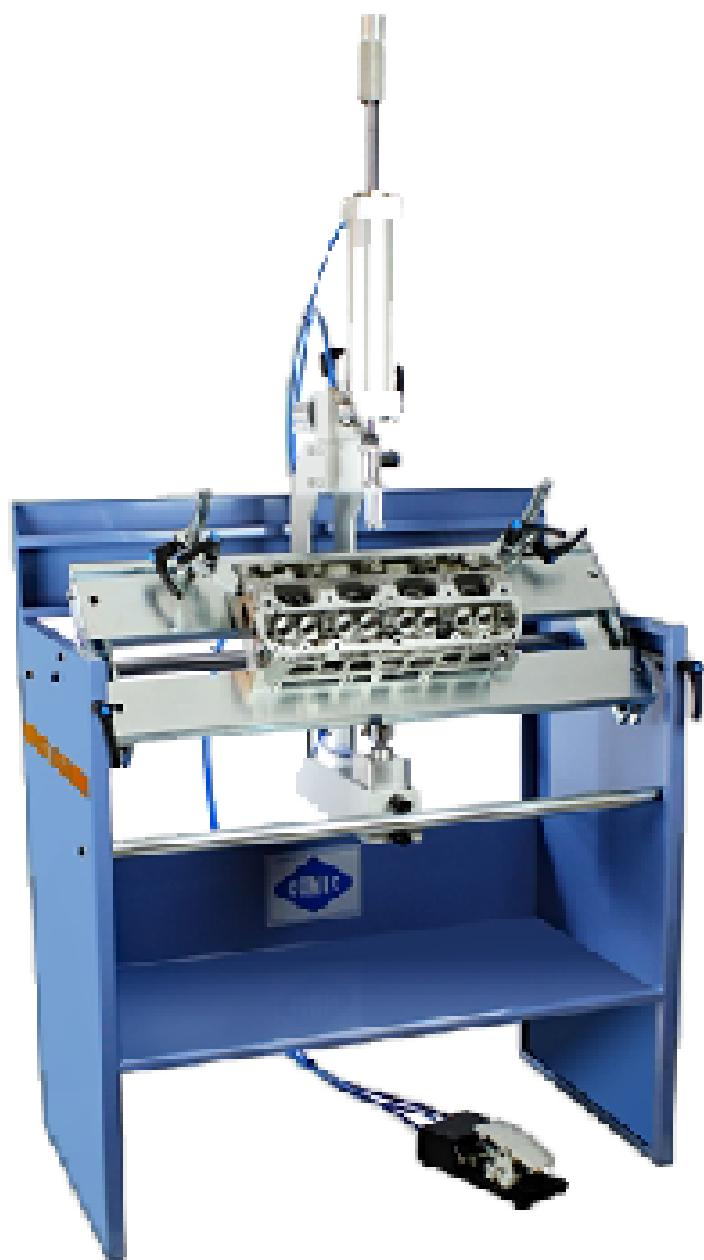
**WORKSTATION FOR CYLINDER HEAD VALVES**
